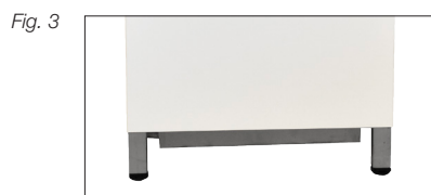
Justera ställskruvarna vid golvmontage.
