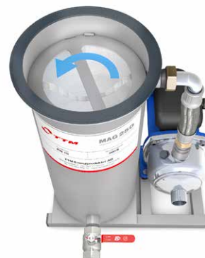
6. Sätt tillbaka låsringen och vrid tills filtret sitter fast.
