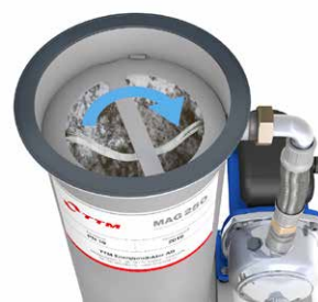
3. Tryck ned och vrid låsringen tills spåren matchar tapparna
